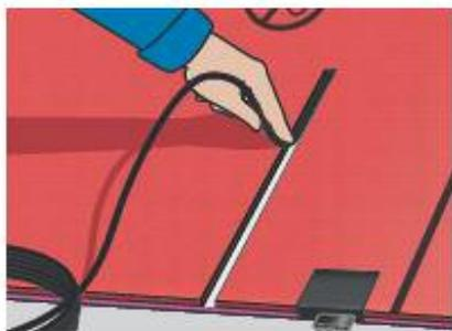
Установка датчика температуры, укладка заполняющего материала на свободную от обогрева площадь
