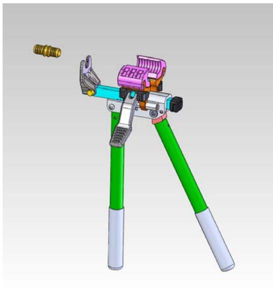
2.3 Установить фитинг в вилку(4) таким образом, что бы специальная проточка на фитинге зафиксировалась в вилке. (рисунок 3)
